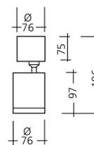
Der Converter ist im Baldachin integriert.
